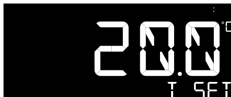
Fig. 21: Réglage de la température de consigne
