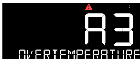
Fig. 40: Exemple : alarme de surchauffe A3 active
