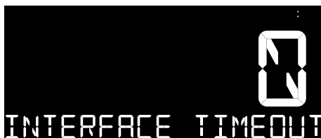
Fig. 30: Surveillance de la connexion dés-activée
